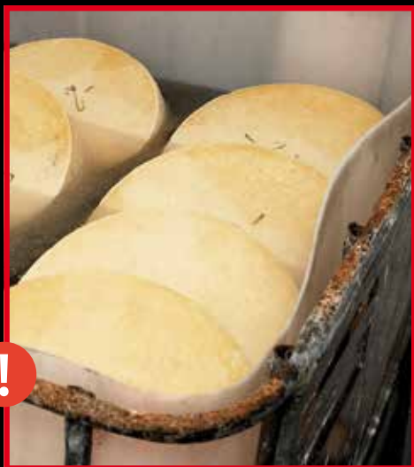
5. Presenza di ruggine nell'attrezzatura
