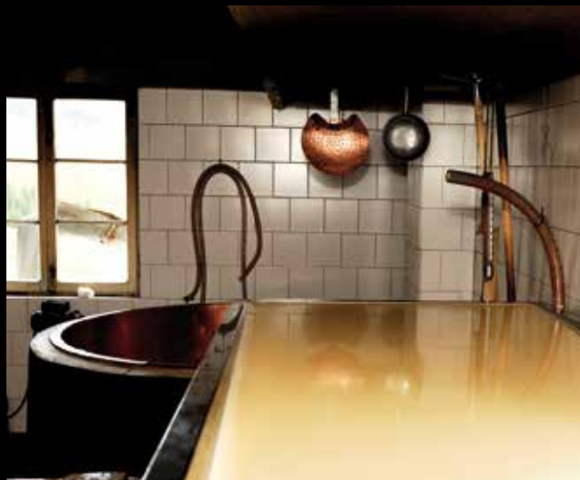
2. Vasca di affioramento
