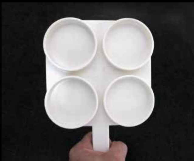
2. Paletta CMT (California Mastitis Test)
